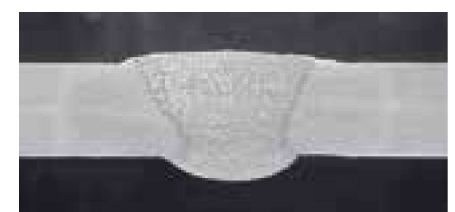
Soldadura de aluminio cabezal con cabezal 4 mm. Óptima penetración y estabilidad del baño. Solda de aluminio cabeça a cabeça de 4 mm. Excelente penetração e estabilidade no banho
